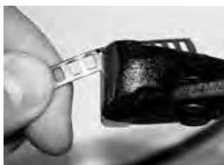
Этап 3 Удалить ненужную часть ленты. Во избежание травм удалить заусенцы с помощью напильника.
