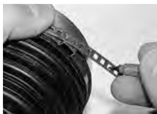
Этап 2 Определить необходимую длину хомута. Убедиться в том, что конец хомута проходит через ушко, как показано на изображении.
