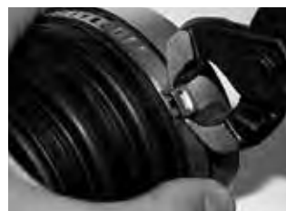
Этап 4 Поместить хомут на зажимаемую деталь. Зафиксировать крючки замка как можно плотнее в соответствующей прорези. С усилием обжать ушко с помощью клещей Oetiker.
